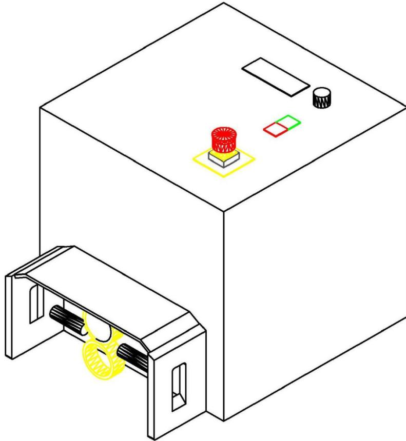
Zuführgerät für Litze bis max. 10mm Durchmesser. Antrieb über Schrittmotor bis max. 1m/sec. Bedienung über Start Stop Taste. Die Parameter können über einen push-dial-button eingestellt werden. Das Gerät verfügt über eine Schnittstelle für eine potentiometrische Schwinde (optional) angeschlossen werden.
